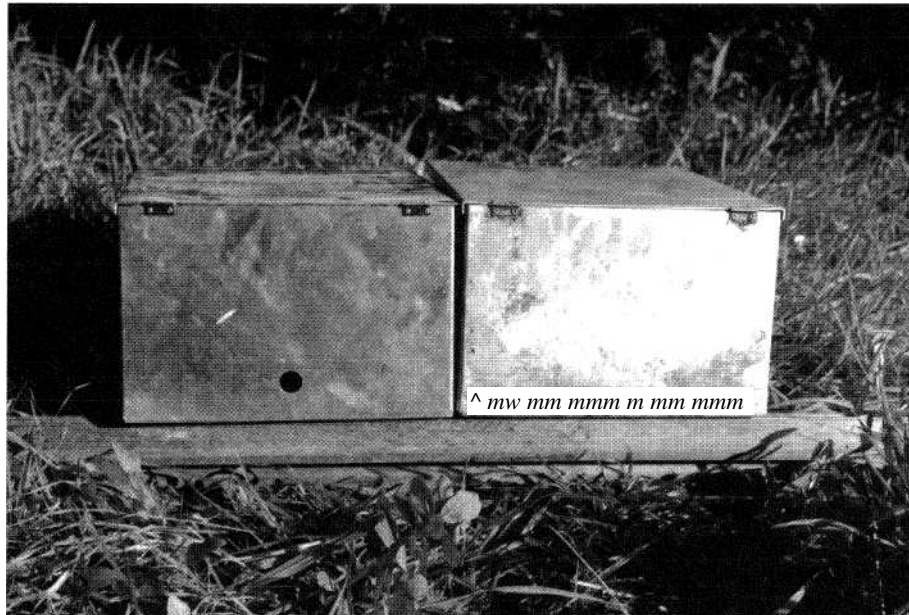
Fot. 10 - Pormenor dos orifícios, que permitem a passagem da água de escorrência, das caixas de erosão colocadas nas parcelas (1 orifício) e das caixas soltas de erosão (vários orifícios).
