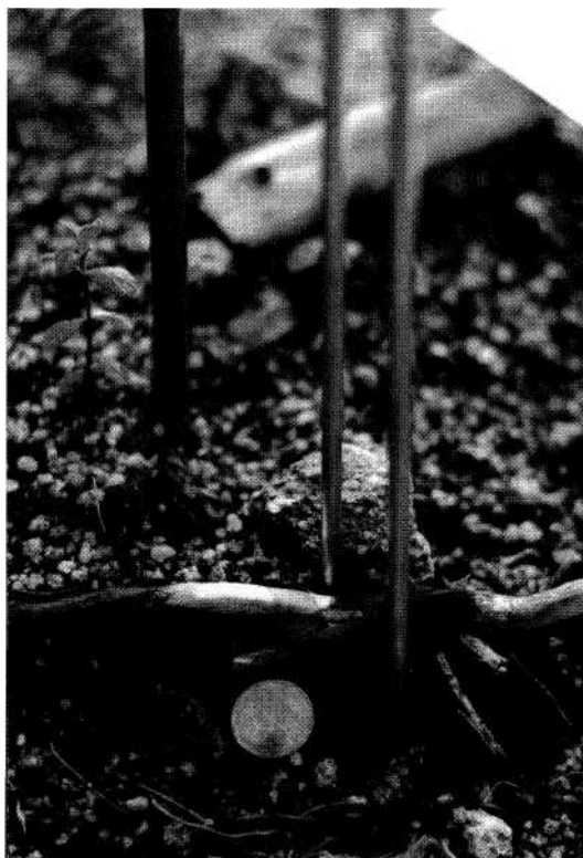
Fot. 16 - Aspecto do desnível das varetas, provocado por pequenos ramos acumulados no solo, quando se fazia uma leitura das estacas de erosão na plantação de eucalipto*
