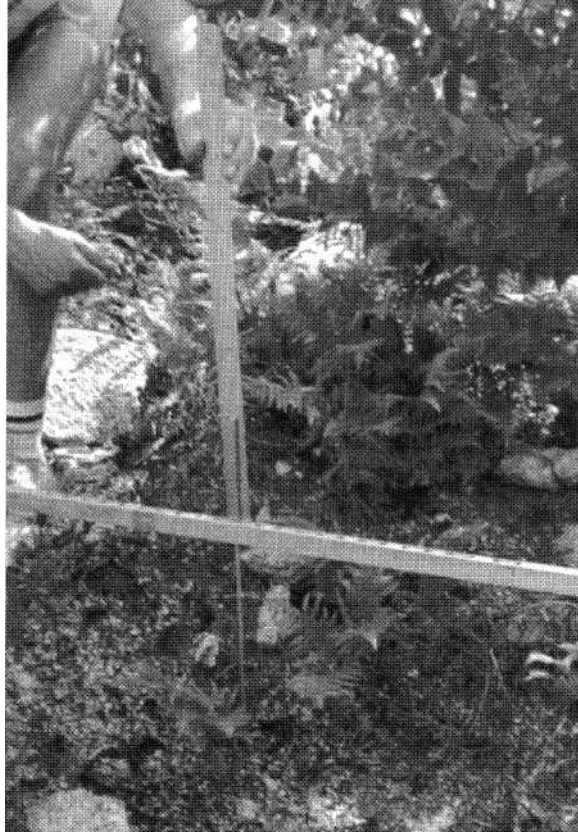
Fot. .11 - Aspecto da técnica de medição da microtopografia do solo com a ponte de erosão.
